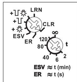
**Mit dem oberen Drehschalter** werden in der Stellung LRN bis zu 35 Funktaster zugeordnet, davon ein oder mehrere Zentralsteuerungs-Taster. Außerdem Funk-Fenster-Türkontakte mit der Funktion Schließer oder Öffner bei geöffnetem Fenster, Funk-Helligkeitssensoren und Funk-Bewegungsmelder. Danach wird damit die gewünschte Funktion dieses Stromstoß-Schaltrelais gewählt:
