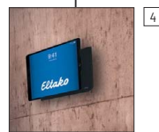
OHJAUSKESKUS, IPAD LATAUSTELAKALLA + GFA5 OHJAUS SOVELLUS
