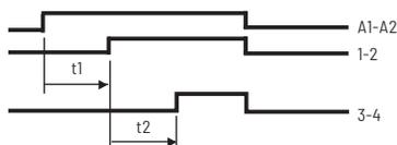
La temporisation pré-réglée t1, réglable entre 0 et 60 secondes, démarre en connectant la tension de commande. A la fin de la temporisation t1 le contact 1-2 se ferme et démarre la temporisation t2 (réglable entre 0 et 60 secondes). A la fin de la temporisation t2 le contact 3-4 se ferme. Après une interruption de la tension de commande la temporisation t1 démarre de nouveau.
